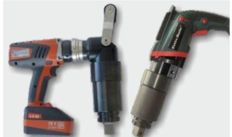
**Spezialservice** für Abschalt-schrauber von InnoTorc® und anderen Anbietern. Optimierung und anwendungsspezifische Einstellung bzw. Nachführung von individuellen Abschalt-Parametern.
