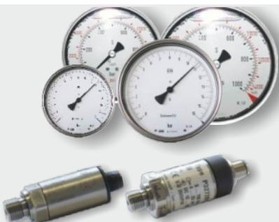
**Kalibrierung von Manometern und Sensoren** in den Bereichen Pneumatik bis 40 bar und Hydraulik bis 1000 bar.
